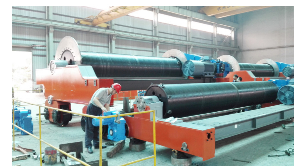
向家坝800t桥机小车行走机构质量检查
