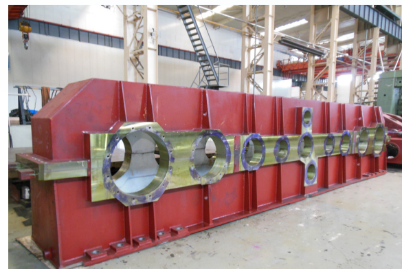
乌东德电站主厂房1300t桥机朱起身减速器箱体机加工完成
