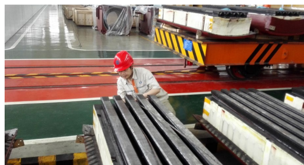
东电监造站：呼蓄2#机磁极铁芯直线度检查
